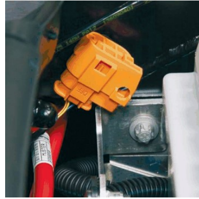
Punto de separación de emergencia de alto voltaje abierto.
