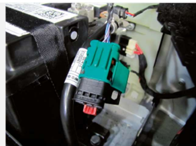
Punto de separación de emergencia de alto voltaje abierto.
