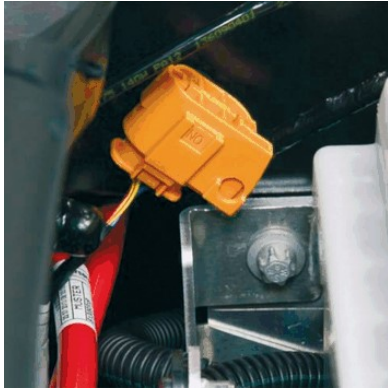
Punto de separación de emergencia de alto voltaje cerrado.
